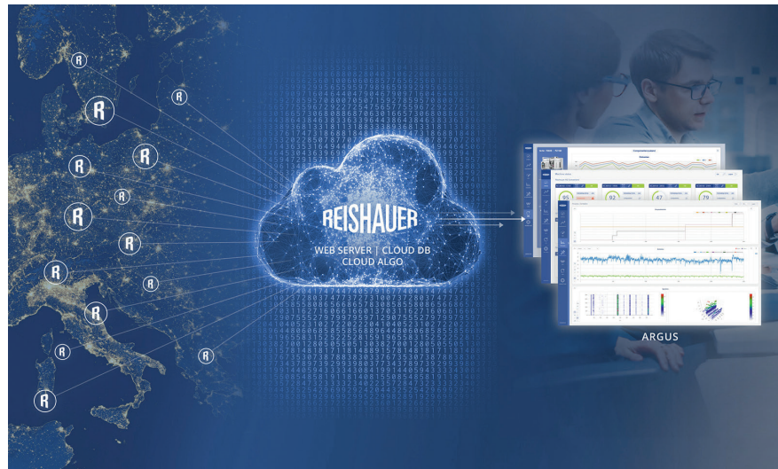
2 Grundsätzlicher Aufbau der Cloud-Architektur von Reishauer für eine Vielzahl von Schleifmaschinen © Reishauer
